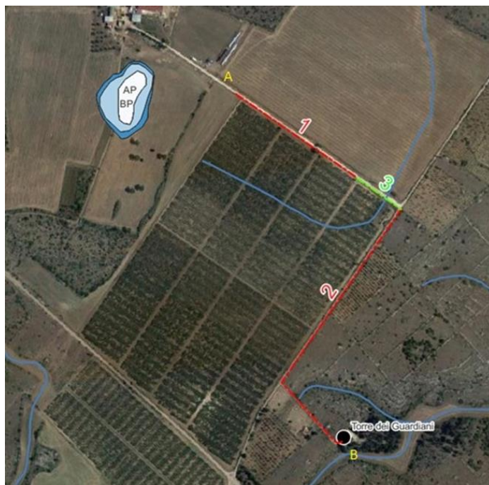
Percorso del cavidotto con tipologia di scavo (rosso scavo a sezione obbligata - verde in TOC)
